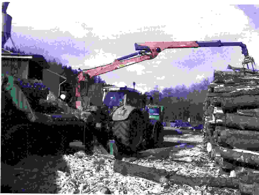
ブリロン市営林から切り出した木材を粉碎機に入れる
